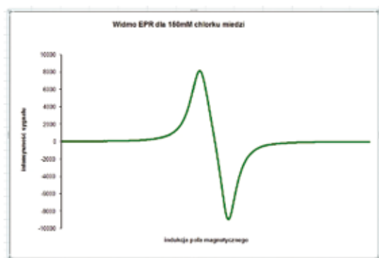
Rys. 3. Widmo EPR miedzi otrzymane dla 150 mM roztworu miedzi \text{CuCl}_2
