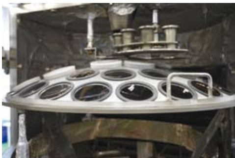
Wnętrze komory próżniowej z kalotą
