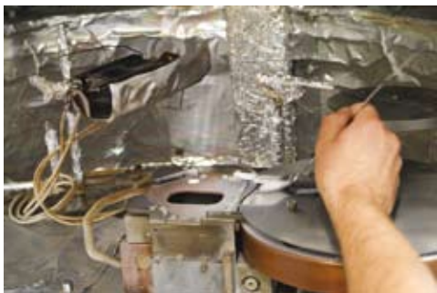
Widok na fragment komory próżniowej – taca z poszczególnymi związkami, które następnie zostaną odparowane podczas procesu nakładania powłoki AR
