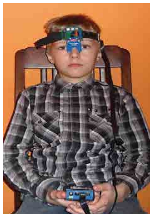
Ryc. 5. Badanie ruchów sakadowych z wykorzystaniem sakadometru
