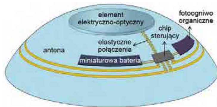
Fot. 1. Przykładowy schemat soczewki bionicznej, na którym widoczny jest układ elektroniczny z anteną, mikrobaterią i chipem [1]
